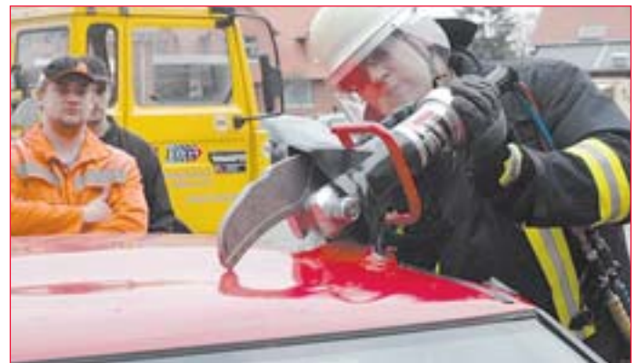
Die hydraulischen Geräte werden an bestimmten Punkten angesetzt, um der Person im Inneren größtmöglichen Schutz zu gewährleisten.
